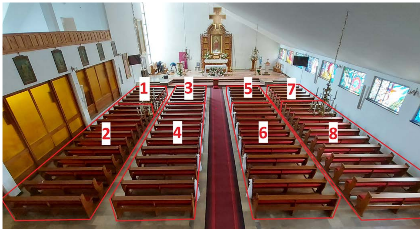
Podział na 8 stref grzewczych w kościele pw. Najświętszego Serca Pana Jezusa w Sokolnikach
